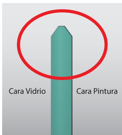
Pulido excesivo de cara pintura que producirá oxidación en la plata.
